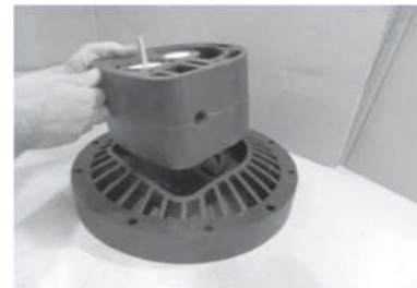
Peso 3 Instale las bridas en la cámaras de aire
