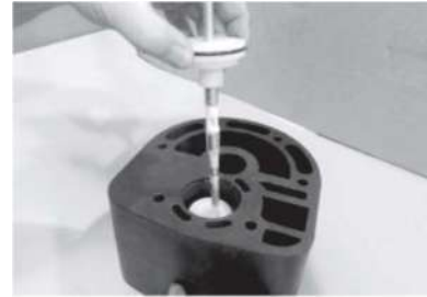
Peso 3a Del lado opuesto retiramos ambos la tapa y el eje de la válvula de aire
