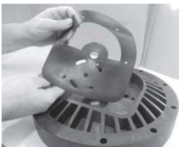
Peso 4 Monte el bloque central con las cámaras de aire.
