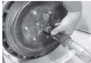
Peso 4 Empujamos hacia afuera la válvula de aire para que salga del bloque central.
